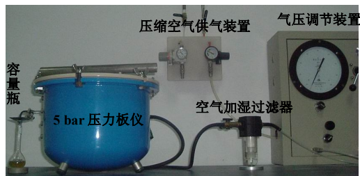
图 2 Cat. No. 1600 压力板仪及其他试验组件
